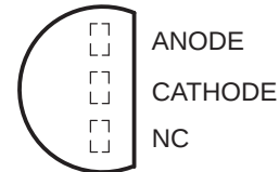
LM285-2.5, LM385-2.5, LM385B-2.5 . . . LP PACKAGE (TOP VIEW)
