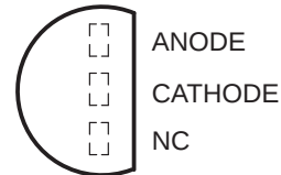
LM285-2.5, LM385-2.5, LM385B-2.5 . . . LP PACKAGE (TOP VIEW)
